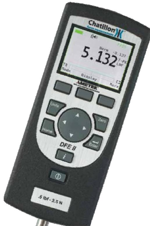
Chatillon DFE II系列开创了数显测力计的新时代。这款小巧、易用的测力计经济实用、功能强大，是手持式或测试台应用的理想选择。DFE II 系列测量范围在 2 lbf (10 N) 到 500 lbf (2500 N) 之间。DFE II 具有一个内置负载传感器，其测量精度达到满量程的 0.25% 以内。一个易读的高分辨率点阵 LCD 全彩大显示屏，支持多种标准测量功能，包括标准和峰值读数、高/低限值、设定值、合格/不合格结果、统计结果、测力元件驱动和方向。负载显示单位为 ozf (盎司力)、gf (克力)、lbf (磅力)、kgf (千克力) 和 N (牛顿)。显示屏可反向显示，操作员甚至可“隐藏”显示的结果。
